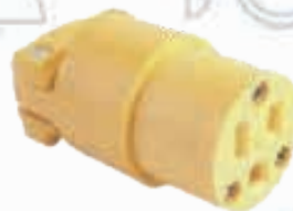
Toma polarizado amarillo termo plastica 15A, 125V, 2P 2W #4887 Nema 5-15R
